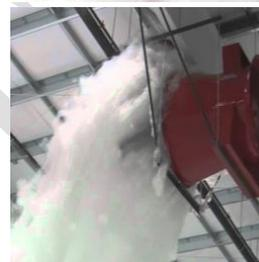
(iv) *impianti Water Mist*: sistemi automatici, solitamente utilizzati in spazi ridotti, che utilizzano spruzzi d'acqua nebulizzata ad alta pressione per controllare o estinguere incendi;
