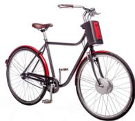
Askoll Eb2 Silver Matt Plus, lanciata nel 2017. La batteria è in ioni di litio con capacità di 300 Wh, autonomia fino a 80 chilometri e tempo di ricarica completa di 5 ore.
