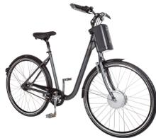
Askoll Eb2, lanciata nel 2016, realizzata in alluminio, ha una batteria in ioni di litio con capacità di 300 Wh, autonomia fino a 80 chilometri e tempo di ricarica completa di 5 ore.
