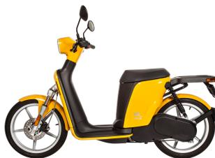
Askoll eSpro K1 (categoria L1), modello destinato a clienti professionali, è stato lanciato nel 2018, ha una potenza di 2700 W e una velocità massima di 45 chilometri orari. È dotato di due batterie in ioni di litio, che complessivamente hanno una capacità di 2800 Wh, ha un'autonomia di 96 chilometri e un tempo di ricarica delle batterie di circa tre ore e mezza per 1 Kwh.
