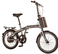
Askoll e-bolt, lanciata nel 2018 e realizzata in alluminio, è un modello di e-bike pensato per i bambini tra i 10 e i 13 anni. La batteria è in ioni di litio con capacità di 300 Wh, autonomia fino a 70 chilometri e tempo di ricarica completa di 5 ore.
