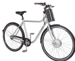
Askoll eBFolding, unico modello pieghevole di *e-bike* alla Data del Documento di Ammissione prodotto dal Gruppo, lanciata nel 2018. La batteria è in ioni di litio con capacità di 300 Wh, autonomia fino a 70 chilometri e tempo di ricarica completa di 5 ore.
