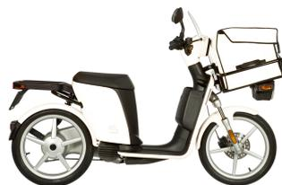
Askoll eSpro K2 (categoria L1), modello destinato a clienti professionali, è stato lanciato nel 2017, ha una potenza di 2700 W e una velocità massima di 45 chilometri orari. È dotato di due batterie in ioni di litio, che complessivamente hanno una capacità di 2800 Wh, ha un'autonomia di 96 chilometri e un tempo di ricarica delle batterie di circa tre ore e mezza per 1 Kwh.
