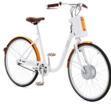
Askoll Eb1plus, lanciata nel 2017, ha una batteria in ioni di litio con capacità di 300 Wh, autonomia fino a 80 chilometri e tempo di ricarica completa di 5 ore.
