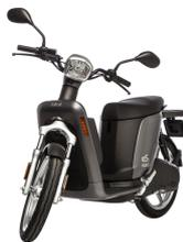
Askoll eSpro 45 (categoria L1), modello destinato a clienti professionali, è stato lanciato nel 2017, ha una potenza di 2700 W e una velocità massima di 45 chilometri orari. È dotato di due batterie in ioni di litio, che complessivamente hanno una capacità
