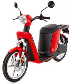
Askoll Es2 (categoria L1) è un modello biposto, lanciato nel 2016, ha una potenza di 2700 W e una velocità massima di 45 chilometri orari. Rientra nella classe L1. È dotato di due batterie in ioni di litio, che complessivamente hanno una capacità di 2100 Wh, ha un'autonomia di 71 chilometri, e un tempo di ricarica delle batterie di circa tre ore per 1 Kwh.
