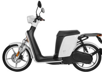
Askoll eSpro 70 (categoria L3), modello destinato a clienti professionali, è stato lanciato nel 2017, ha una potenza di 3000 W e una velocità massima di 70 chilometri orari. È dotato di due batterie in ioni di litio, che complessivamente hanno una capacità di 2800 Wh, ha un'autonomia di 96 chilometri e un tempo di ricarica delle batterie di circa tre ore e mezza per 1 Kwh.
